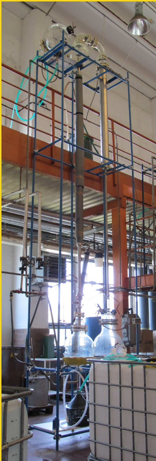
Stípcová odparka. Využíva sa napríklad na dealkoholizáciu piva alebo vína.
