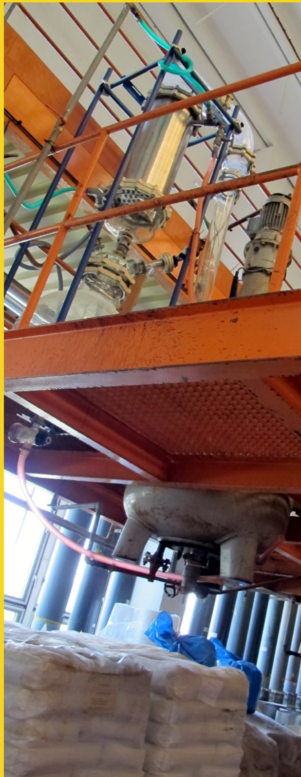
Hydrolyzačný varný kotol pre teploty do 100 °C, bez chladiča. Využíva sa napríklad na hydrolýzu ražného škrobu pred kvasením.
