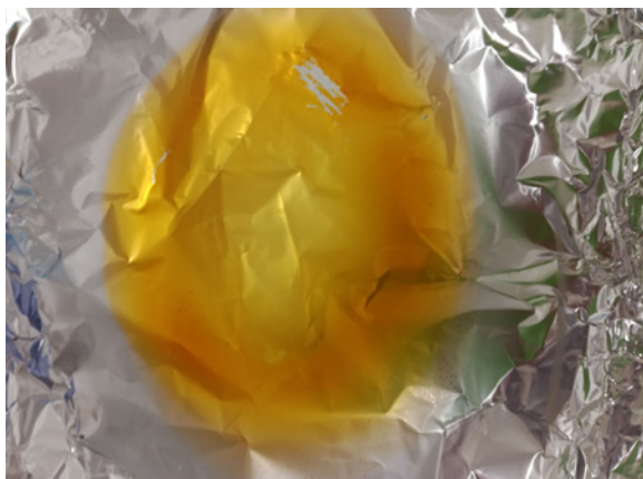
Obr. 3. Výsledok elektrostatického sprejovania.
