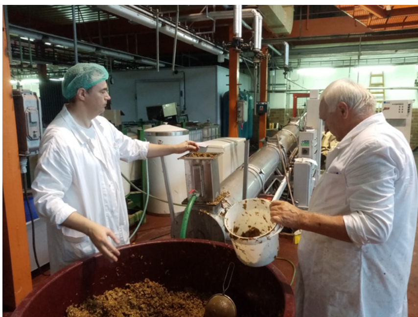
Obr. 1. Extrakcia hroznových výliskov v poloprevádzkových podmienkach NPPC VÚP Biocentrum Modra (na obrázku Ing. E. Kiss a doc. Ing. S. Šilhár, CSc.).
