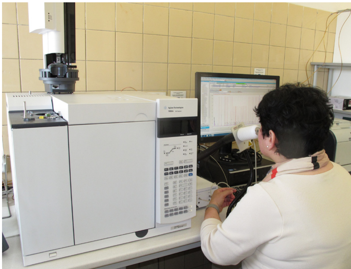
Analýza prchavých aróma-aktívnych látok plynovou chromatografiou – olfaktometriou,
