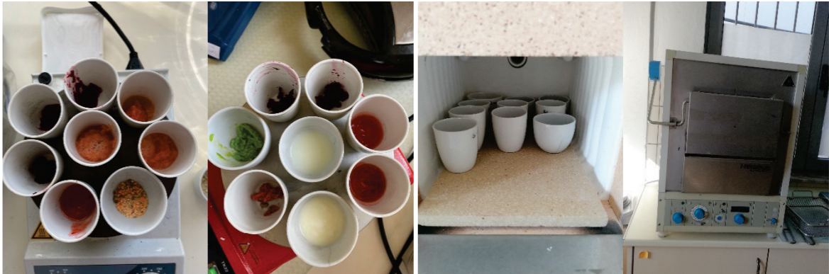
Figure 13: Hiri total i përcaktuar me furrën muffël
