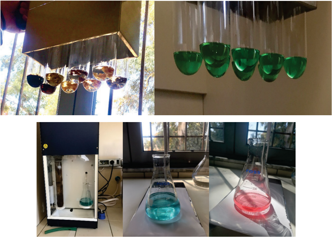
Figura 10: Proteina totale e përcaktuar me metodën Kjeldahl
