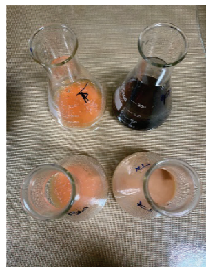
Figura 7: Mostrat e titruara me tretësirë standarde të nitratis të argjendit 0,1 N deri në pikën përfundimtare të kuqe-tulle
