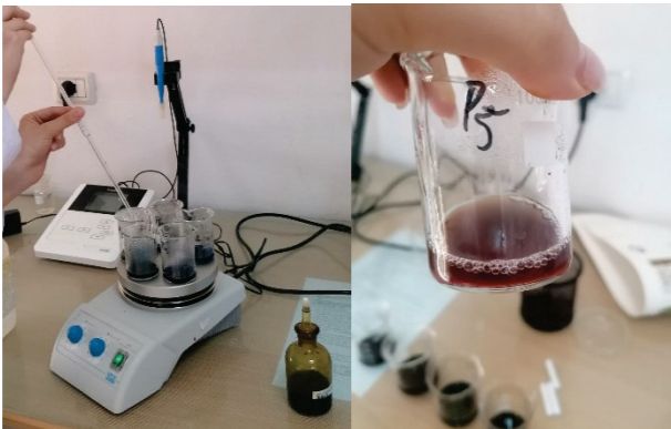
Figure 12: Sheqernat e përcaktuara me metodën volumetrike Lane dhe Eynon
