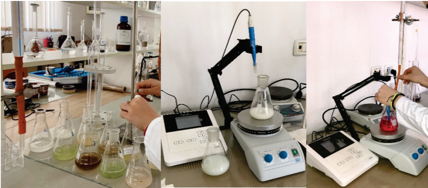
Figure 14: Aciditeti total i përcaktuar me metodën potenciometrike
