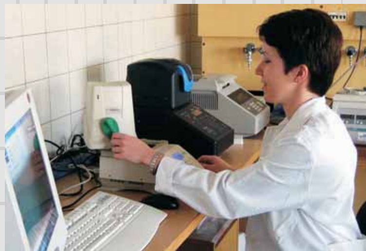
Obrázok 2: Real-time PCR sa realizuje v termocykléri s integrovaným fluorometrom
