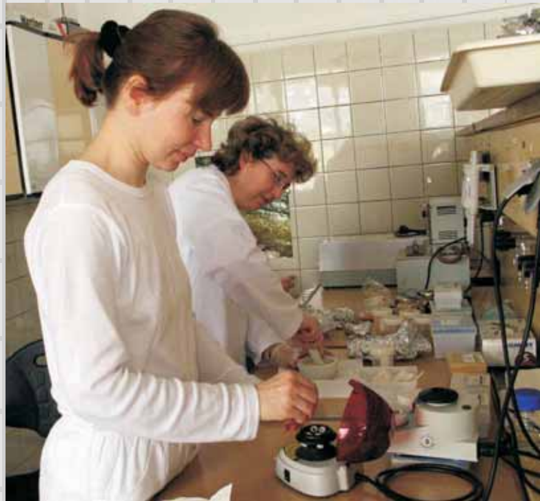
Obrázok 1: Predpokladom presných výsledkov analýzy je dôkladná homogenizácia vzorky pred nasledujúcou izoláciou DNA.
