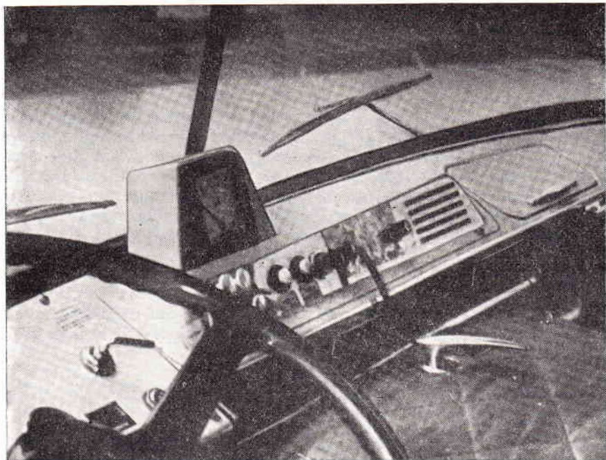
Abb. 5. Armaturenbrett des Versuchsfahrzeuges mit Bedienungs- und Kontrollgeräten für die Stickstoffkühlung
