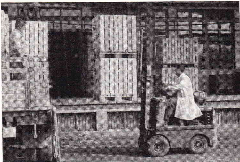
Obr. 8. Vykladanie ohradových paliet vysokozdvížnym vidlicovým vozíkom.
