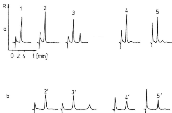
Obr. 2. Chromatografické záznamy nealkoholických nápojov s prídavkom acesulfamu K (po riedení 1:50). a – stanovenie pred začiatkom skladovania, b – stanovenie po 187 dňoch skladovania pri 40 °C. 1 – štandard acesulfamu K 5 mg.l -1 , 2, 2' – Zeus, pomarančový džús, 3, 3' – Olympus, 4, 4' – Pepsi-cola, 5, 5' – Mirinda.
